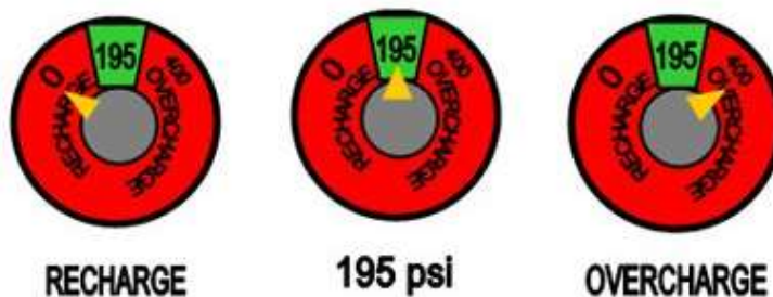
ภาพประกอบที่ ๔.๔ การตรวจสอบความพร้อมใช้งานเครื่องดับเพลิงยกหัวที่มีมาตรวัดแรงดัน
