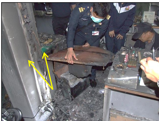
ลักษณะเขม่าควันไฟแบบตัววี (V-Shape)
